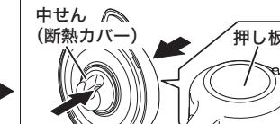
※中せんの穴に指をあて、押し板を押し最後まで下がるようでしたら、ペローズが損傷しています。
