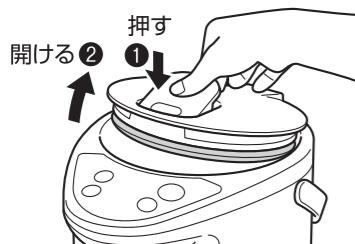
**音** ふたを開閉するとき「カラ、カラ」と音がしますが、お湯の流出を防止する弁(せんバルブ)の音です。
